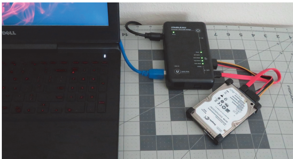
Rysunek 8.10. Konfiguracja fizycznej blokady zapisu
